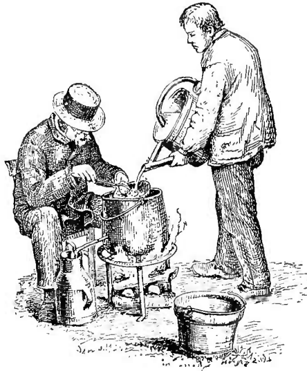
Fig. 211. — Fabrication simplifiée de la cire.
