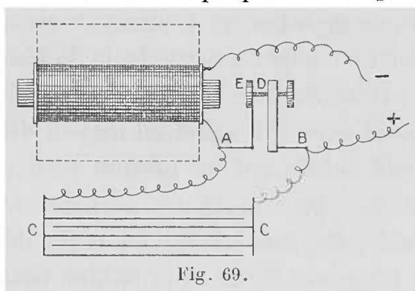
duit la variation. Or, dans la bobine inductrice, la variation de rupture étant plus courte que celle de fermeture, le courant induit direct, correspondant à la rupture a plus de force électromotrice et d'intensité que le courant inverse déterminé par la fermeture.
