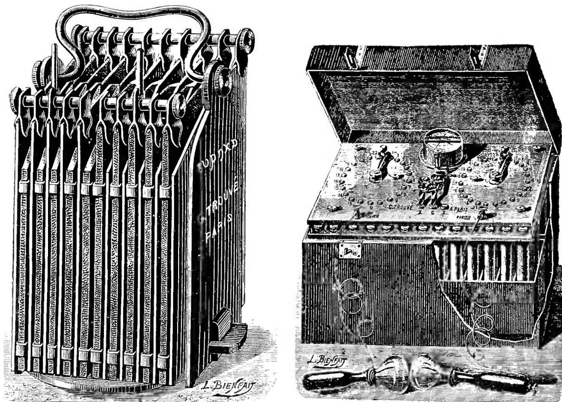
Fig. 52 et 53. — Batteries de Trouvé au bichromate.
