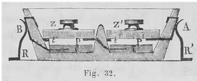
de charbon et zinc, au nombre de deux ou trois, reliés par des communications en platine et montés dans une petite cuvette d'ébonite. Une pincée de sulfate de bioxyde de mercure et un peu d'eau fournissent la charge de chaque couple, charge qu'il faut renouveler à chaque séance, mais qui permet un travail de plus d'une demi-heure de durée.
